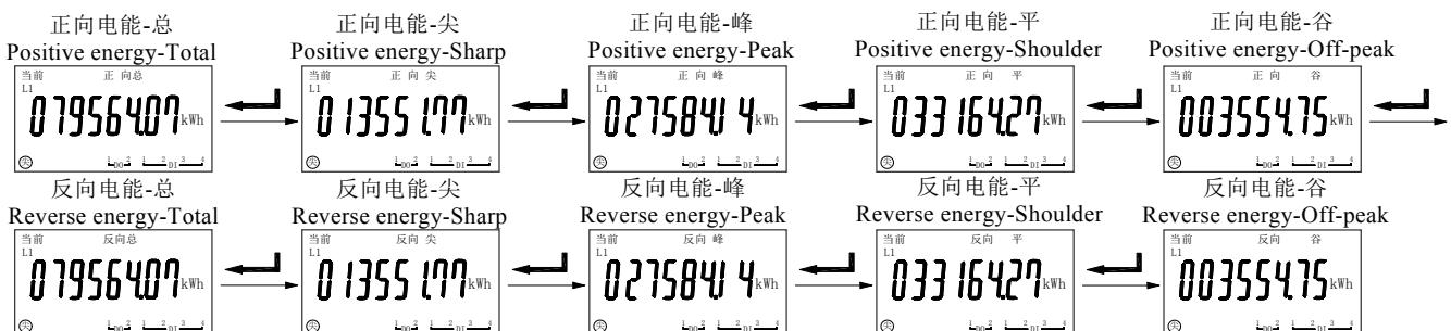
仪表开机后显示电流显示界面时，按右键切换到历史月电能查询显示界面后，按回车键切换显示：所查月正向有功电能（尖）→所查月正向有功电能（峰）→所查月正向有功电能（平）→所查月正向有功电能（谷）→所查月反向有功电能（总）→所查月反向有功电能（尖）→所查月反向有功电能（峰）→所查月反向有功电能（平）→所查月反向有功电能（谷）→查询电能的日期设置（年、月）。
