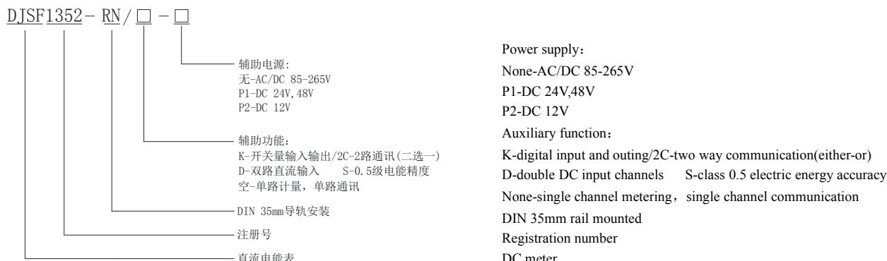
注：1、选配双路直流输入（D）功能时，如果电流通道均采用的是霍尔电流传感器输入，则需外配一个电源模块给第二路的霍尔传感器供电；如果未带D功能，则可使用电表内置电源。
